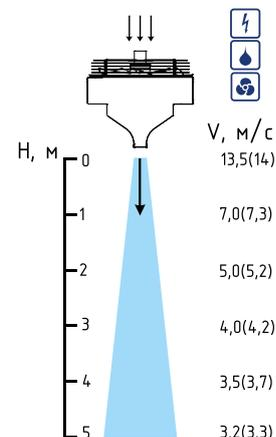
Завесы из оцинкованной или нержавеющей стали с осевыми вентиляторами.
